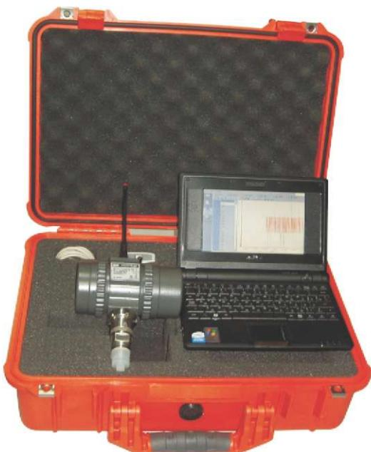
Комплекс приборов "Трасса ТК" предназначен для дистанционного мониторинга и контроля технологических параметров на потенциально опасном оборудовании (котлы и емкости, находящиеся под давлением) и проведении полевых испытаний (опрессовки) на ремонтных и вновь вводимых в эксплуатацию участках газонефтепроводов.
