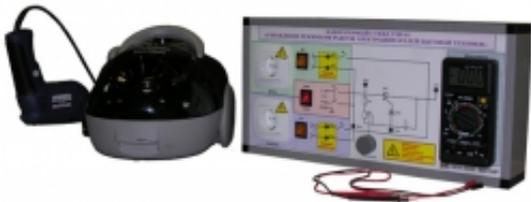
Лабораторный стенд УПР-01 «Управление режимами работы электродвигателей бытовой техники» предназначен для использования в качестве учебного оборудования при проведении лабораторно-практических занятий.
