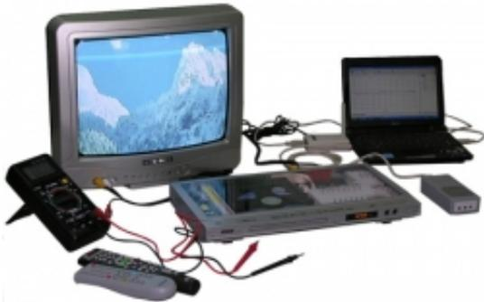
Стенд-тренажер РБТ-03 «Ремонт и обслуживание DVD-плеера» предназначен для использования в учебном процессе при проведении лабораторного практикума и практических занятий. Стенд позволяет изучать устройство и взаимодействие блоков DVD-плеера.
