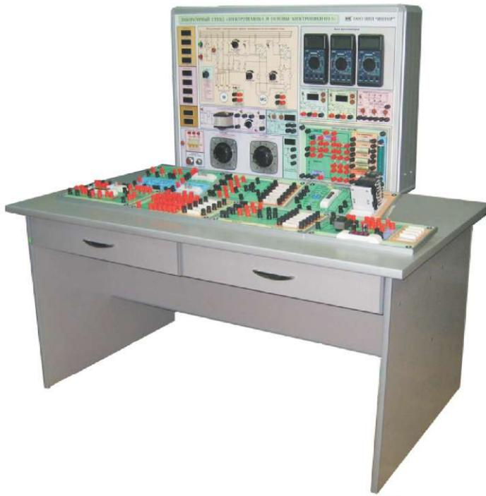
Комплекс ЭиЭМ - 01 позволяет исследовать линейные и не линейные цепи постоянного и переменного тока, определять параметры и исследовать режимы работы трехфазных цепей, определять параметры и основные характеристики однофазного трансформатора и электрических машин, исследовать параметры и режимы работы полупроводниковых приборов.
