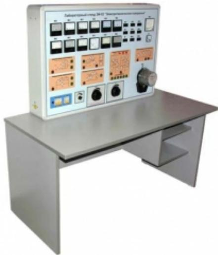
Принцип работы стенда основан на использовании различных схем измерения в электрических цепях тока. Измерения осуществляются с помощью большого набора цифровых и стрелочных приборов, вынесенных на лицевую панель стенда и графического изображения электрических схем, отображенных на ней, которые коммутируются внутри стенда.
