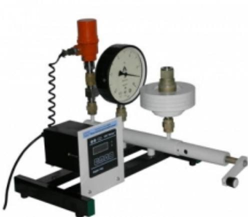
Лабораторная установка ИД-01 выполнена в виде моноблока, содержащего грузопоршневой манометр, образцовый стрелочный манометр, вторичный цифровой преобразователь, с функцией двухпозиционного регулирования и одного или нескольких датчиков избыточного давления.
