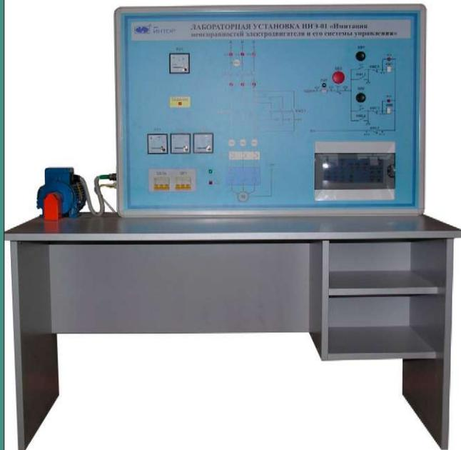
Лабораторная установка предназначена для использования в качестве учебного оборудования при проведении лабораторно-практических занятий. В процессе проведения практических и лабораторных занятий, преподавателем имитируются основные неисправности электродвигателя и его системы управления. Задача учащихся определить вызванную на лабораторной установке неисправность и устранить ее.
