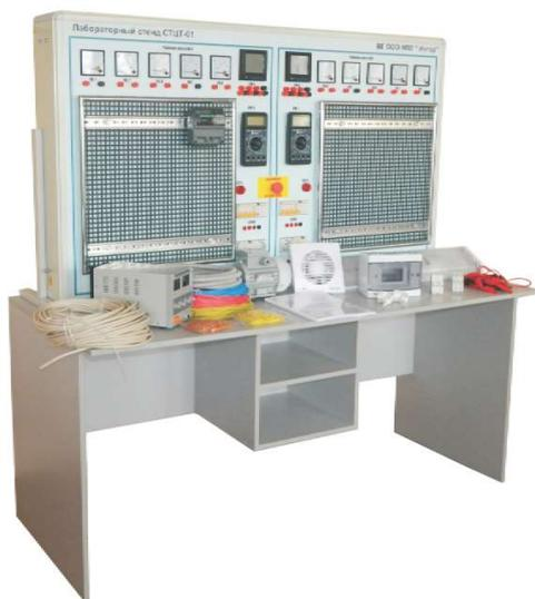
Лабораторный стенд СТЦТ-01 предназначен для использования в учебном процессе при проведении лабораторных и практических занятий при обучении студентов с целью получения ими практических навыков работы с различными элементами и приборами при монтаже схем освещения, автоматики, пожарной и охранной сигнализации и др.
