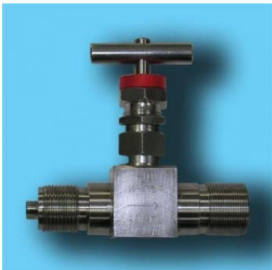
Кран запорный установочный **УК-1/250** предназначен для монтажа датчиков давления и манометров на технологическом оборудовании. Применение крана позволяет осуществлять монтаж и демонтаж измерительных систем без отключения давления в подводящих трубопроводах. Кран рассчитан на применение в магистралях с рабочим давлением до 25 МПа и температурой до 90 °С.
