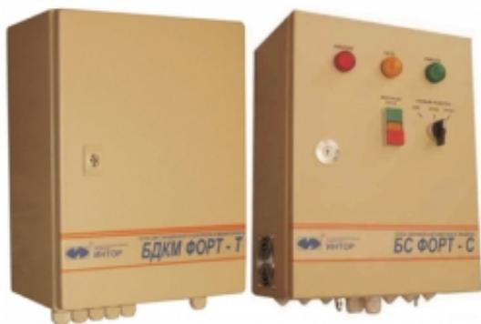
Система управления и защиты СУЗТ "ФОРТ-М" предназначена для автоматического управления погружным (дренажным) насосом в различных режимах работы, защиты трехфазного электродвигателя и передачи данных о состоянии агрегата и технологических параметрах на диспетчерский пункт. СУЗТ может применяться в системах холодного и горячего водоснабжения на промышленных, коммунально-бытовых, общественных и частных объектах.
