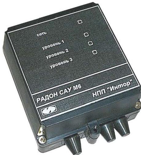
Сигнализатор уровня жидкости «Радон САУ-М6» совместно с кондуктометрическими датчиками уровня и исполнительными механизмами предназначен для создания систем управления уровнем жидкости в резервуарах, накопительных емкостях, отстойниках и т.п., при условии, что используемая рабочая жидкость обладает электропроводностью.
