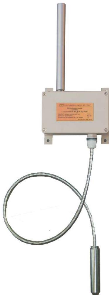
Радиотелеметрическая система обеспечивает постоянный контроль уровня грунтовых вод в пьезометрических скважинах гидротехнических сооружений, передачу сигнала скважины посредством радиоканала на приемное устройство и далее на компьютеры (гидротехнической службы объекта, района, управления и т.д.).
