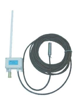
Датчики давления «Радон ТК-СИ» предназначены для измерения и хранения во внутренней памяти значений избыточного давления (уровня) нейтральных и агрессивных сред. Связь с датчиком осуществляться по радиоканалу с частотой 433,92 МГц. Работает датчик автономно от встроенной литиевой батареи. Время разряда батареи зависит от настроек датчика (периода связи и периода сохранения данных) и может составлять от 1 года до 10 лет.
