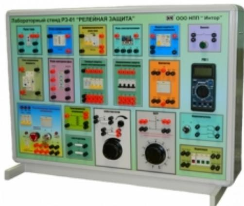
Лабораторный стенд «Релейная защита» РЗ-01 предназначен для использования в качестве учебного оборудования при проведении лабораторно-практических занятий. В процессе проведения лабораторного практикума он позволяет исследовать основные принципы действия релейной защиты и автоматики, а так же
