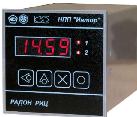
Преобразователь «Радон РИЦ» является многофункциональным прибором и предназначен для измерения унифицированного входного сигнала постоянного тока, электрического питания преобразователя, непрерывного отображения измеряемого параметра или его производных, задания начальных режимов индикации, а так же для формирования логических сигналов, при отклонении измеряемого параметра от значений, задаваемых уставками.
