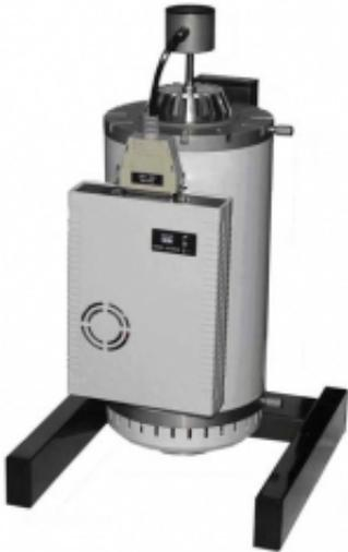
Позволяет производить исследования объекта в режиме постоянной и линейно нарастающей температуры (до 11 ступеней); накопления и обработки опытных данных и представления их в графическом и табличном виде.
