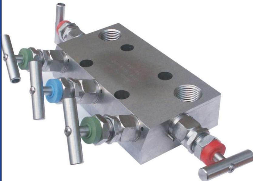
Блок пятивентильный «БВ-5/250» предназначен для использования в измерительных и регулировочных системах промышленной автоматики при закрытии импульсных трубопроводов в случае необходимости отключения датчиков давления или дифманометра, а также для выравнивания вводимых давлений во время настройки нуля датчика разности давлений, удаления воздуха и продувки системы
