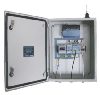
Устройство «БДКМ-GSM-1» предназначено для сопряжения датчиков с унифицированным выходом, термопреобразователей и частотных датчиков, с системой управления и контроля по GSM-сети. Устройство питает первичный преобразователь и обеспечивает местную индикацию измеряемого параметра, формирует логические сигналы при отклонении измеряемого параметра от заданных значений.
