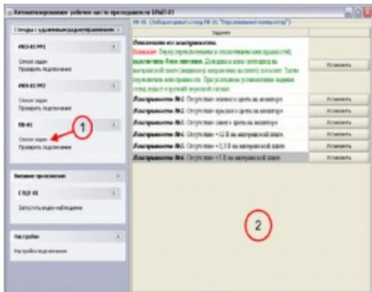
Основа автоматизированного рабочего места преподавателя - оригинальное программное обеспечение. Основные функции ПО "АРМП-01" - удаленный контроль за работой лабораторных станций (возможно из соседнего кабинета), задача неисправностей и пр. Работа осуществляется по радиоканалу с несущей частотой 433 МГц. Возможно подключение ряда станций, имеющих компьютерное управление.
