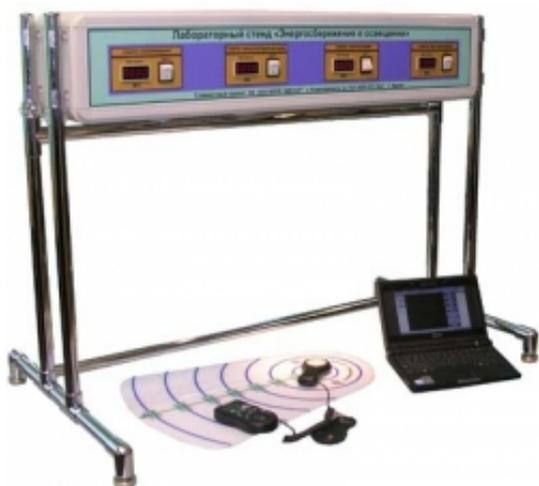
Лабораторный стенд ЭО-01 предназначен для формирования учащимися практических навыков по изучению типов традиционных и энергосберегающих источников освещения (лампа накаливания, энергосберегающая лампа, галогенная лампа, источник освещения с применением ярких светодиодов).
